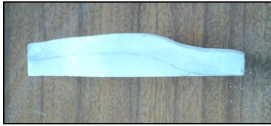
Fig. 4.29 : Profile du guide de lumière monolithique torsadé après broyage
