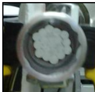
Fig. 4.13 : Fibres optiques regroupées en faisceau hexagonal
