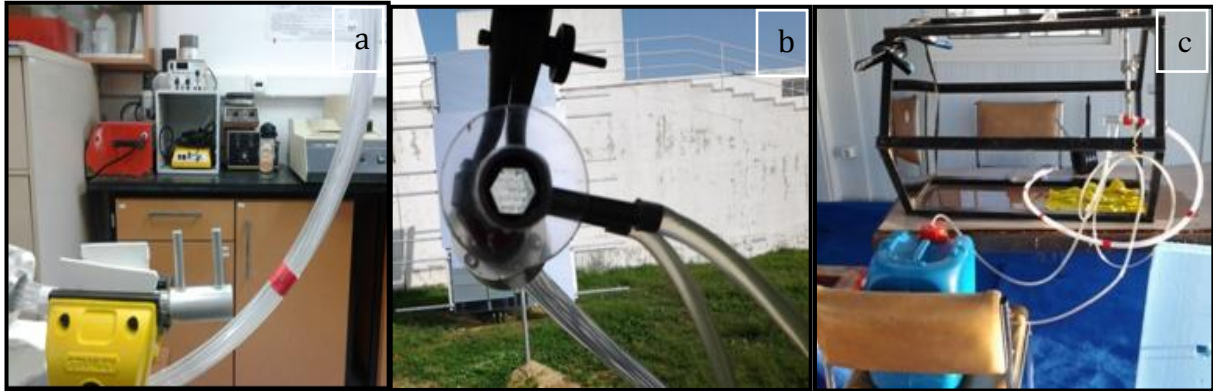
Fig. 4.14 : Système de refroidissement, (a et b) Trous et tubes d'injection et d'évacuation d'eau, (c) Réservoir avec le système de pompage
