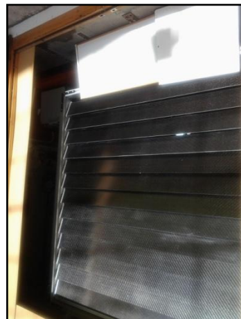
Fig. 4.35 : Volet de contrôle de la lumière solaire incidente sur le concentrateur parabolique
