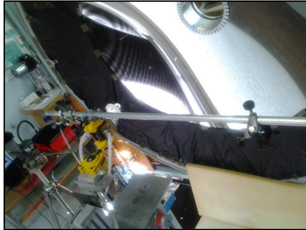
Fig. 4.36 : Concentrateur "miroir" parabolique
