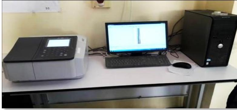
الشكل (20-II): جهاز التحليل الطيفي (UV-VIS).
