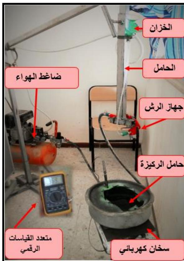
الشكل (III-1): التركيب التجريبي لترسيب الأغشية الرقيقة بتقنية الرش الكيميائي الحراري.
