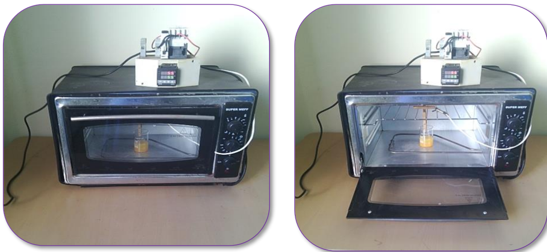
الشكل (1-III): يمثل منظومة عملية الترسيب بتقنية CBD.
