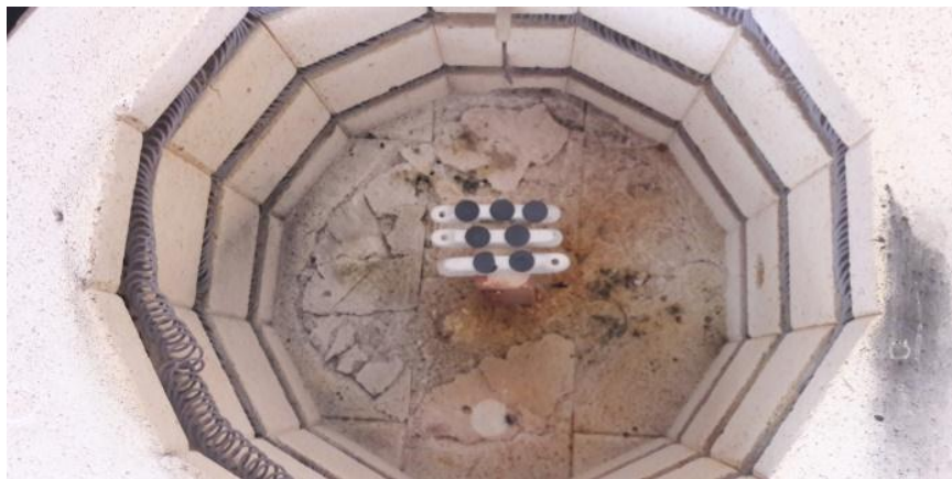
الشكل (II-13): الأقراس المشكلة داخل الفرن تحضيراً لعملية تلييدها.
