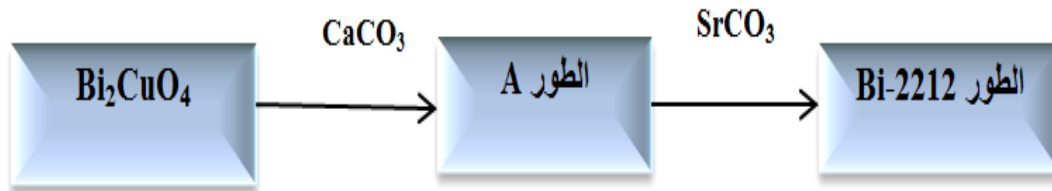
الشكل (II-5): مخطط يلخص آلية تشكل الطور Bi-2212.
