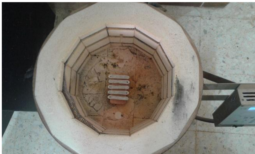
الشكل (II-10): وضعية المساحيق في الفرن تحضيريا لبدأ معالجة الكلسنة.
