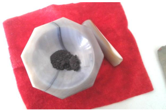
الشكل (II-9): المسحوق المتجانس بعد عملية المزج و السحق
