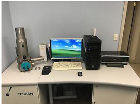
الشكل (II-19): صورة للمجهر الإلكتروني الماسح المستعمل.
