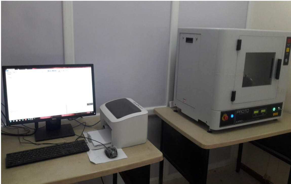
الشكل (II-17): صورة لجهاز الحيود المستعمل في دراسة العينات.
