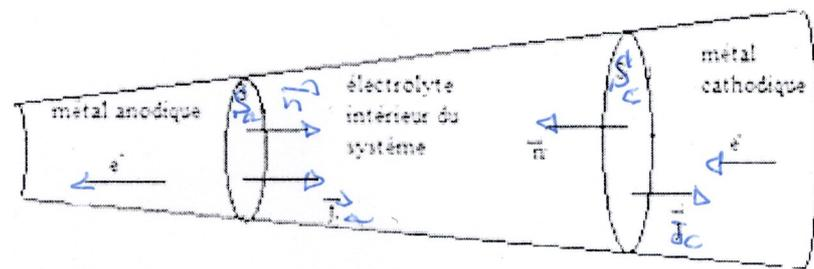
$I$  par convention le courant "entre" dans le système normale orientée dans le même sens que la densité de courant
