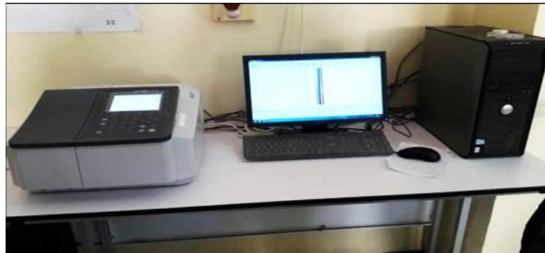
الشكل (20-II): جهاز التحليل الطيفي (UV-VIS).
