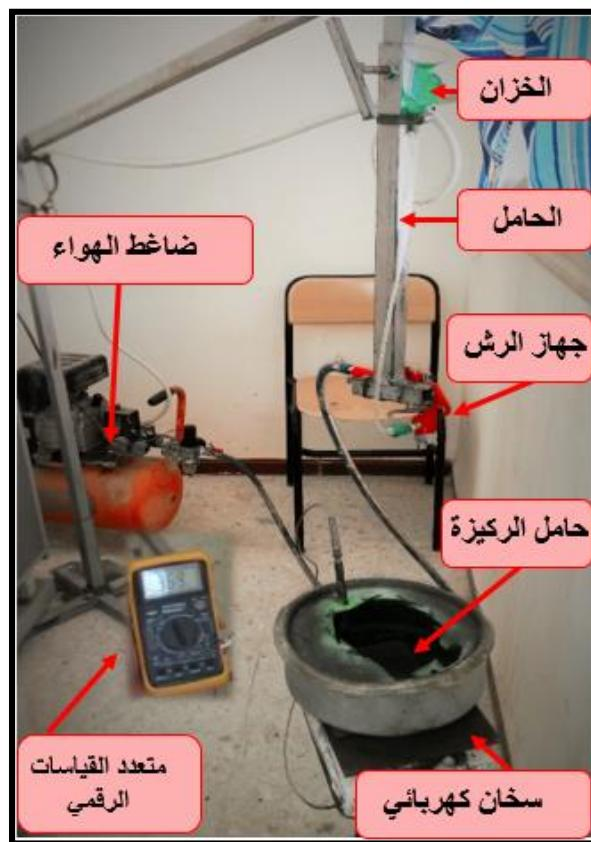
**الشكل (1-III):** التركيب التجاري لترسيب الأغشية الرقيقة بتقنية الرش الكيميائي الحراري.
