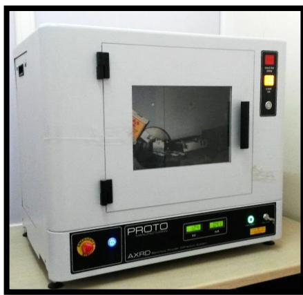
الشكل (15-II): جهاز إنراجم الأشعة السينية (XRD) المستخدم.
