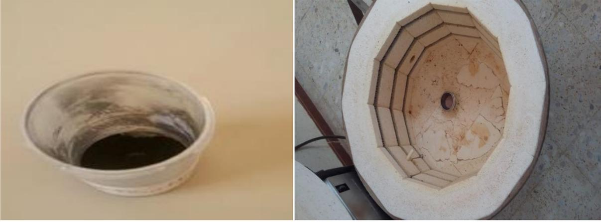
5- وضع العينة في الفرن للمعالجات الحرارية. الشكل (3-2): خطوات تحضير العينة  $\delta\text{-SrFe}_{0.7}\text{Mo}_{0.3}\text{O}_{3-\delta}$  بطريقة محلول - هلام.
