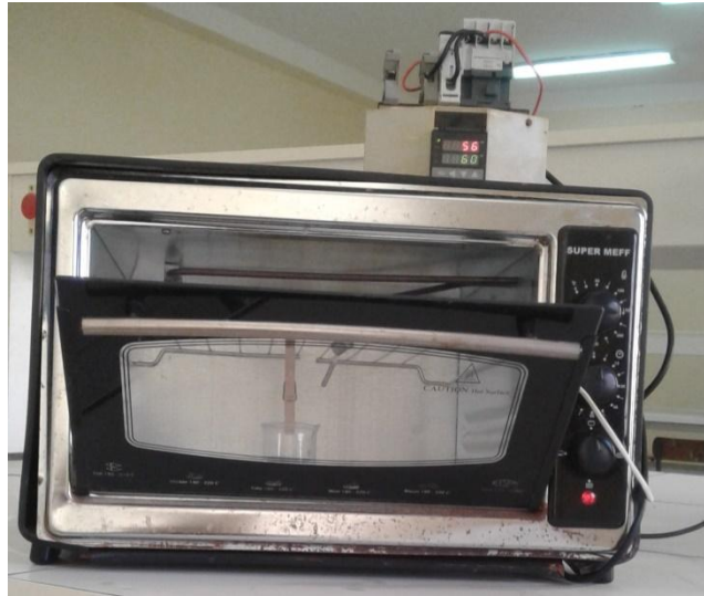
الشكل (III-2): البروتوكول التجريبي لترسيب أغشية رقيقة بواسطة "تقنية الترسيب بالحمام الكيميائي".
