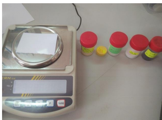
الشكل (3-1): الميزان الإلكتروني والأكاسيد والكربونات الأولية المكونة للخليط.
