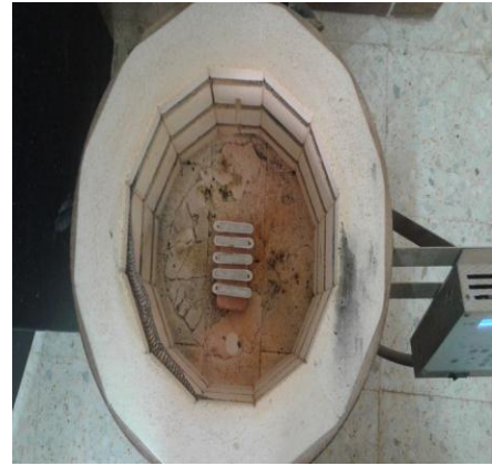
الشكل (3-7): وضعية المساحيق في الفرن تحضيراً لبدء معالجة الكلسنة.
