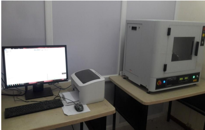
الشكل (2-8): صورة لجهاز انعراج الأشعة السينية المستعمل في دراسة العينات.
