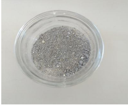
الشكل (3-3): المنتج الأولي المتجانس بعد عملية المزج و السحق.
