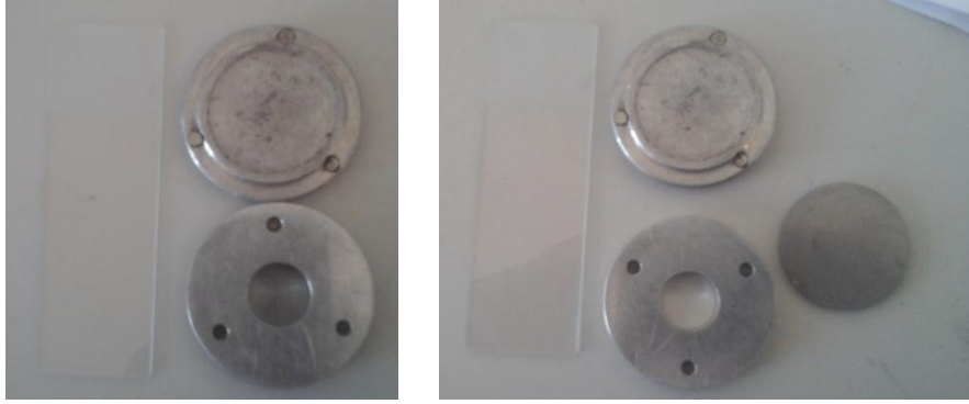
الشكل (3-7) : أدوات تحضير عينة قياس XRD.
