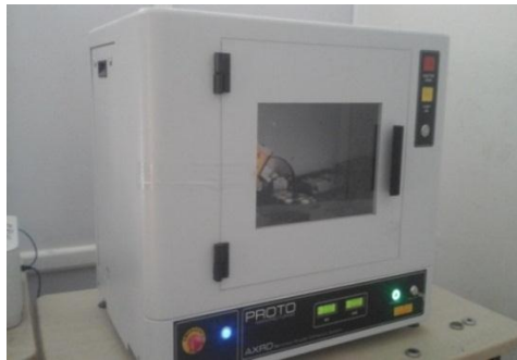
الشكل (6-3) : جهاز الإنعراج الآلي من نوع PROTO AXRD.
