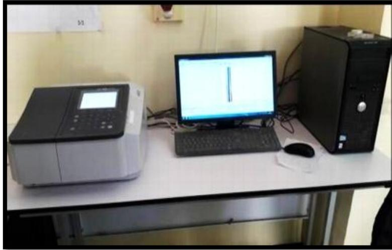
الشكل(II.20): جهاز التحليل الطيفي(UV-VIS)[15].
