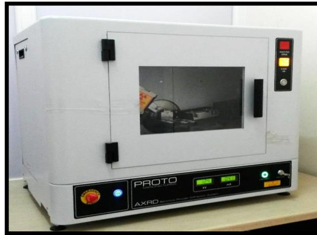
الشكل (14.II): جهاز انعراج الأشعة السينية (XRD) المستخدم [15].
