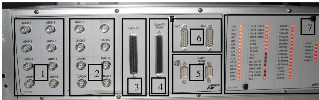
Fig.(VI.3): Panneau de connexion de la *DSPACE1104* (*CLP1104*).
