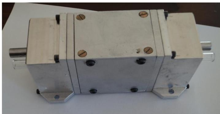
**Figure 5:** Tête laser avec des électrodes externes.
