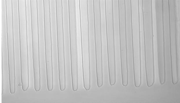
**Figure 2 :** image au microscope du PPLT 1D utilisé
