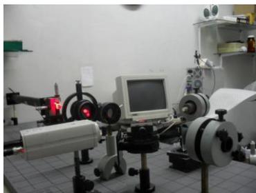
**Figure 1:** Image photographique de l'interféromètre de Michelson : Séparatrice faite de TiO<sub>2</sub>.
