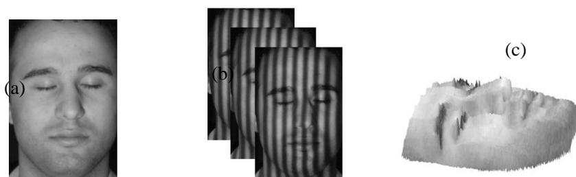
**Figure 5:** Résultat obtenu pour un visage en utilisant un vidéo projecteur : (a), image réelle, (b) images d'intensité, visage reconstitué en 3D avec texture.
